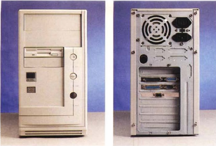
I pannelli anteriore e posteriore. Nonostante le piccole dimensioni del cabinet, il frontale può ospitare due unità di memoria di massa estraibili.
